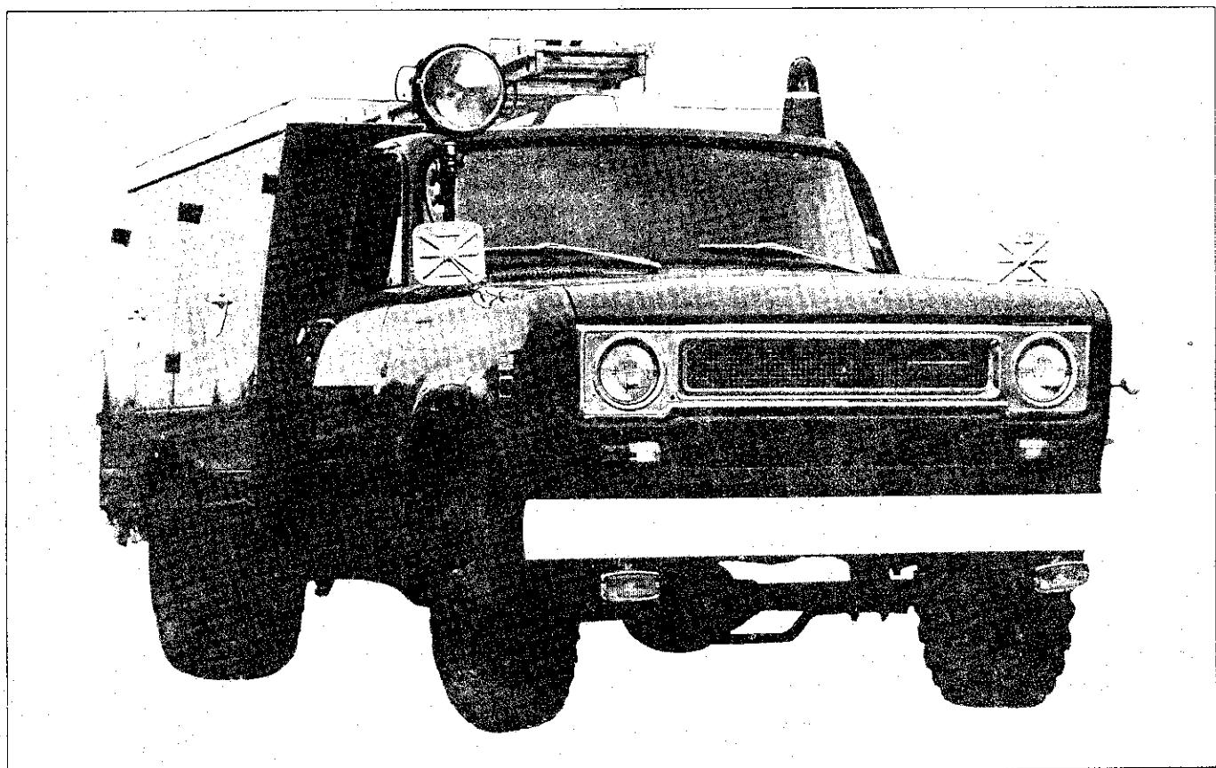
Ein allradgetriebenes Kleintanklöschfahrzeug für Betriebs- und frw. Feuerwehren. Sehr schnell und wendig durch optimales Leistungsgewicht durch 200-PS-Benzinmotor. 1200 l Kunststoffwassertank (nur 7 kg Gewicht!).
